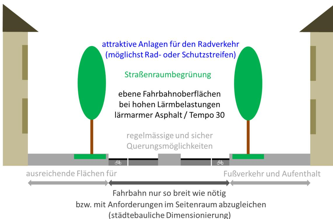
**Abb. 31** idealtypischer Straßenquerschnitt im Sinne der Lärmminimierung
